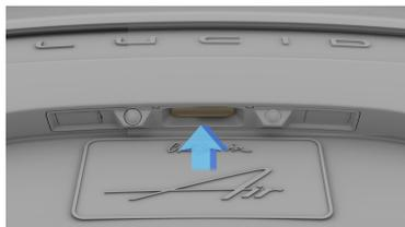
2. Ouvrez le coffre et retirez le dispositif de remorquage situé sous le panneau de plancher du coffre du côté droit.
