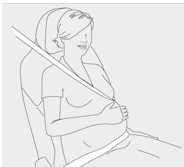
La ceinture sous-abdominale doit être portée le plus bas possible au niveau des hanches, et non au niveau de la taille. Positionnez la ceinture épaulière entre les seins et sur le côté de l'abdomen. Assurez-vous que la ceinture de sécurité
