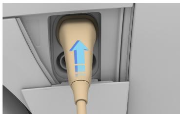
**⚠ MISE EN GARDE : Lucid** recommande de ne pas utiliser d'adaptateurs entre le connecteur du câble de recharge et la prise de recharge du véhicule. Certains chargeurs peuvent produire un courant électrique supérieur aux limites nominales de nombreux adaptateurs. L'utilisation d'un adaptateur ne convenant pas au courant produit peut provoquer une chaleur excessive et endommager la prise de recharge. Pour obtenir de l'aide, consultez Contacter Lucid Motors à la page 282.
