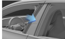
Tenez la carte-clé Lucid juste au-dessus de la caméra de montant central côté conducteur pour verrouiller ou déverrouiller les portes.
