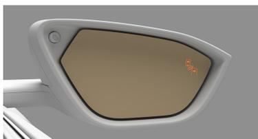
La LED ambre du rétroviseur s'allume du côté où un objet est détecté dans un angle mort.
