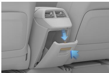
Tirez sur le verrou pour dégager le couvercle du compartiment de rangement et laissez-le s'ouvrir. Appuyez sur le couvercle pour le fermer.
