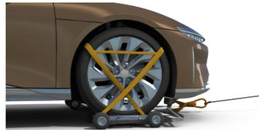
Veillez à attacher le véhicule sur la remorque comme indiqué dans les instructions du fabricant du chariot, de sorte qu'il reste bien positionné sur les systèmes Dolly.
