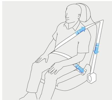
Les prétendeurs rétractent automatiquement les ceintures de sécurité, ce qui réduit le mou dans les ceintures sous-abdominales et d'épaule, et donc le mouvement vers l'avant de l'utilisateur de la ceinture de sécurité.
