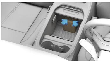
2. Deux autres ports USB-C à l'arrière de la console centrale avant.
