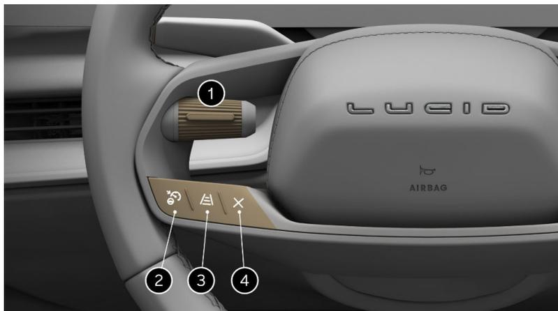
1. Interrupteur à bascule gauche
