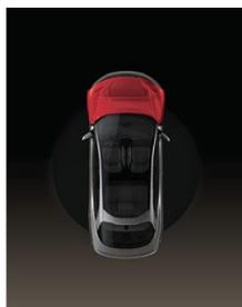
Si le véhicule est en position **D** (marche avant) ou **R** (marche arrière) et que le capot est déverrouillé, il apparaît en rouge.
