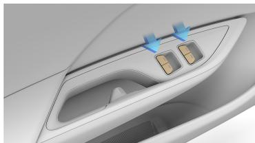
Les commandes de vitres de la porte du conducteur contrôlent toutes les vitres du véhicule. Tirez la commande vers le haut ou appuyez dessus pour remonter ou abaisser la vitre correspondante.
