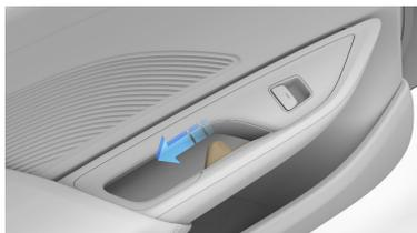
Lorsque le sélecteur de vitesses est en position Stationnement, tirez une fois sur la poignée de déverrouillage (mise en évidence ci-dessus) pour déverrouiller et ouvrir la porte.
