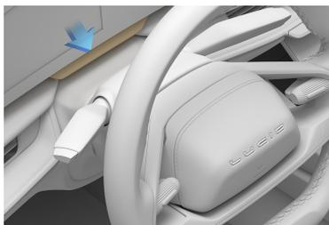
La caméra intérieure est située sur le tableau de bord, directement derrière le volant.
