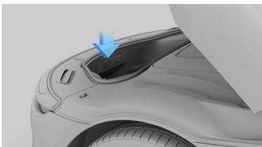
Si une personne est coincée dans le coffre avant, vous pouvez ouvrir le capot de l'intérieur en appuyant sur le bouton d'ouverture intérieur.
