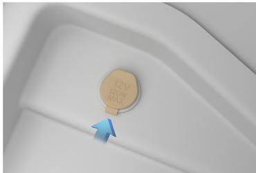
Bien que la prise d'alimentation soit principalement destinée à l'utilisation de la trousse de réparation de pneu, elle
